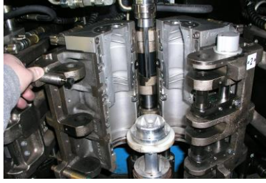
ทำความสะอาดแม่พิมพ์พรี ฟอร์ม (Preform Moulds)
