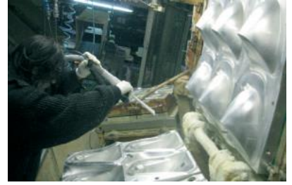
ทำความสะอาดแม่พิมพ์ (Polyurethane)
